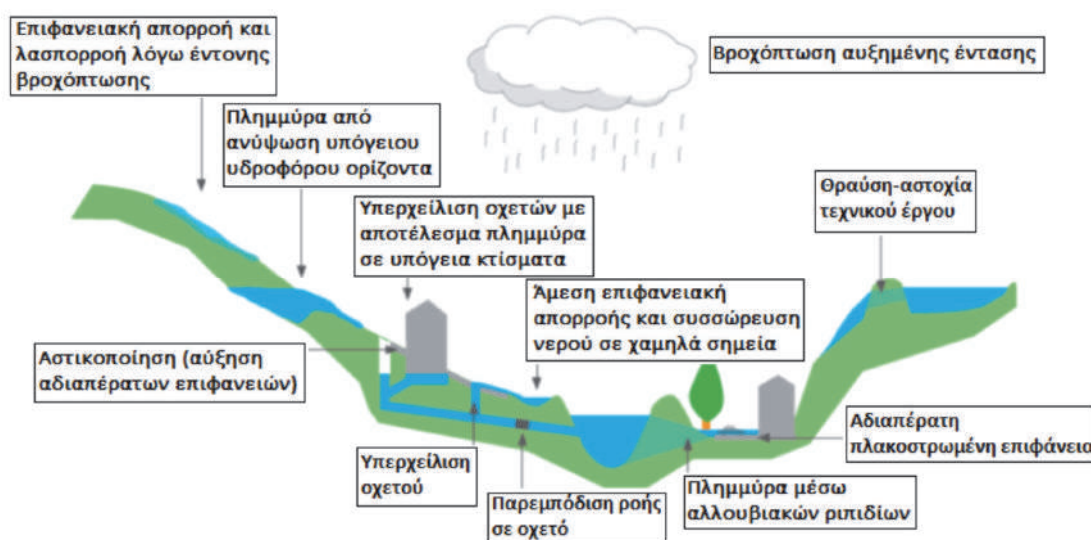
Εικόνα 5-3 Κύρια αίτια και τύποι πλημμυρών
